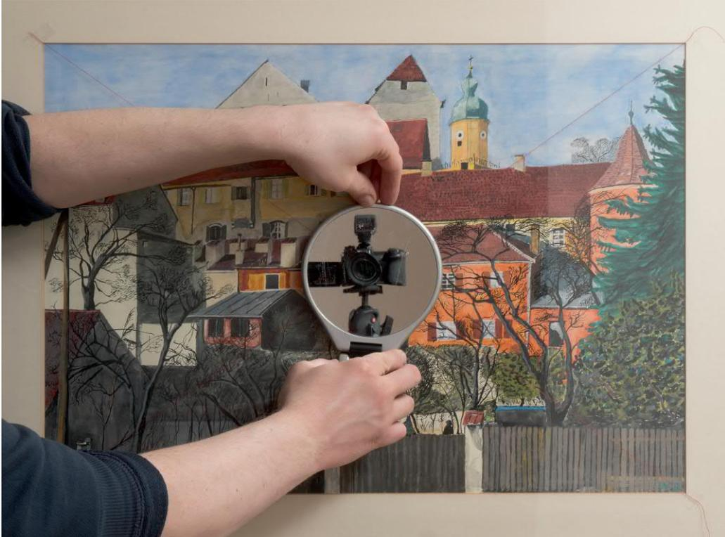
Ausrichtung der Kamera mittels Fadenkreuz und Spiegel
