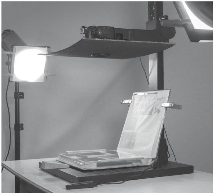
Aufgeklappte Seite eines Fotoalbums (mit beschwerter Glasplatte für bessere Planlage sowie schwarzem Karton ums Objektiv zur Vermeidung direkter Reflexionen)
