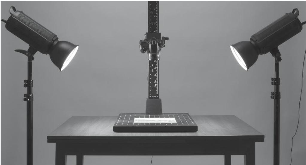
Typischer Aufbau aus Kamera, Repro-Stativ und zwei Studioblitz
