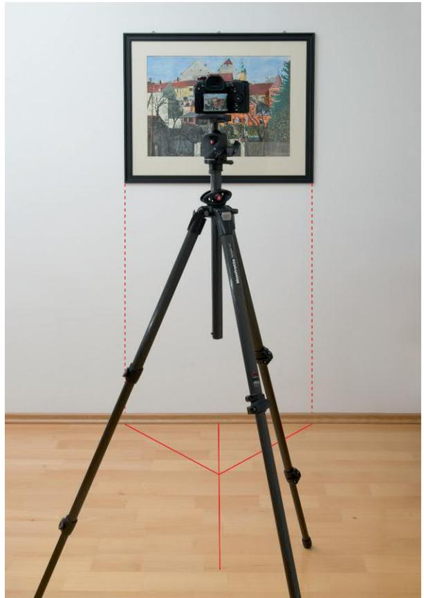
Ausrichtung des Stativs mit Hilfe von Linien bzw. Fäden
